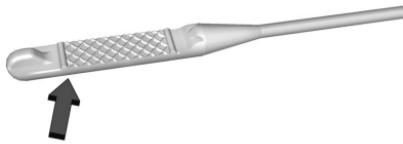
엔진 오일 레벨이 딥스틱 끝의 십자 무늬 밑에 오고 엔진이 최소 15분간 정지해 있었다면 권장 엔진 오일을 1리터 이상 보충하고 레벨을 다시 점검하십시오. 어떤 종류의 엔진 오일을 사용해야 하는지는 본 단원 뒤에 나오는 '엔진 오일 선택'을 참조하십시오. 엔진 오일 크랭크케이스의 용량은 440페이지의 '용량과 규격'을 참조하십시오.
