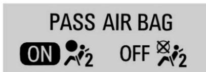
시동을 걸면 시스템 점검의 일환으로 동승석 에어백 상태 표시등(ON과 OFF)이나 심벌(꺼짐 심벌과 꺼짐 심벌)이 몇 초 켜집니다. 몇 초 더 지나면 동승석 에어백 상태 표시등(ON 또는 OFF)이나 에어백 켜짐/꺼짐 심벌로 동승석 프런트 에어백의 상태를 알 수 있게 됩니다.
