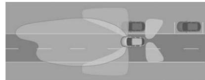
조작 라이트(장착시)는 기어가 R에 있고 차량 속도가 7km/h 미만일 때 자동으로 켜집니다. 주차 할 때와 같이 차를 앞뒤로 조작하는 상황에서 조명이 개선됩니다.
