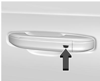
열거나 잠그려는 도어나 리프트게이트에서 1m 이내에 리모트 키가 있어야 합니다. 도어를 해제하고 열려면 해당 도어 외부핸들 안쪽의 터치패드를 누릅니다. 도어를 잠그려면 해당 도어 외부핸들 앞면의 센서를 터치합니다. 9페이지의 ‘리모트 키의 작동’ 항목에 나오는 ‘키리스 개폐 가능’을 참조하십시오.
