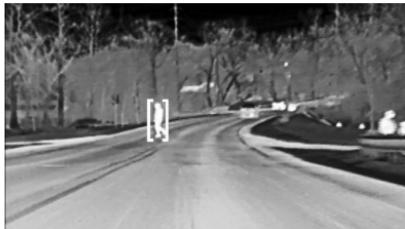
보행자 브레이크 시스템을 켜 놓으면 차가 보행자나 동물에 너무 빨리 접근할 때 나이트 비전 시스템이 HUD에 적색 경고등을 켭니다. 이와 더불어 경고음(삐소리)이 나거나 운전석(안전경고 기능 내장시)이 진동할 수도 있습니다. 309페이지의 '전방 보행자 브레이크 시스템(FPB)'을 참조하십시오.
