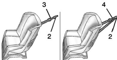
상부 묶음띠(3/4)는 어린이 안전시트 상부를 차에 고정시키는 데 사용합니다. 차에 한 개의 상부 묶음띠 앵커가 만들어져 있습니다. 어린이 안전시트의 상부 묶음띠 부착구(2)를 차의 상부 묶음띠 앵커에 연결하면 운전할 때나 충돌이 있을 때 어린이 안전시트가 앞으로 쓸리거나 돌아가는 것이 방지됩니다.
