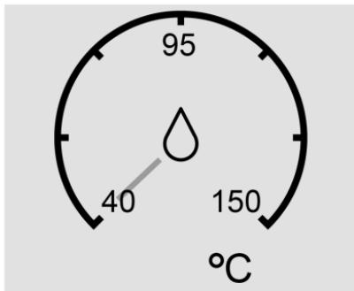
변속기 온도 게이지에는 변속기 오일 온도가 표시됩니다. 게이지 바늘이 적색 영역으로 들어가거나 DIC에 경고 메시지가 나타나면 차를 세우고 원인을 조사해야 합니다. 변속기 오일 부족은 하나의 원인이 됩니다.
