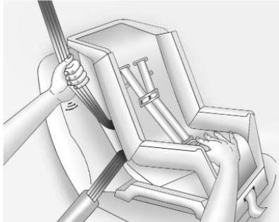
5. 안전벨트를 조이려면 어린이 안전시트를 밑으로 누르면서 어깨벨트를 당겨 허리벨트를 조이고 어깨벨트를 리트랙터로 들여보냅니다. 전향 어린이 안전시트를 설치할 때는 무릎으로 어린이 안전시트를 밑으로 누르면서 안전벨트를 조이는 것이 편리합니다.
