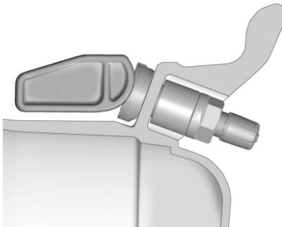
트레일러 타이어에 TTPMS 센서를 설치하려면 트레일러 서비스 센터나 타이어 서비스 센터에 연락하십시오. 기술자가 센서 스템을 트레일러 휠의 구멍에 삽입해야 합니다. 센서가 자리를 잡으면 센서 스텰의 너트를 8N.m으로 조여야 합니다. 트레일러 휠에 타이어를 장착할 때는 센서를 손상시키지 않도록 조심하십시오.
