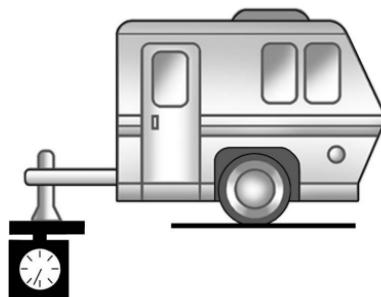
트레일러 연결대 중량은 차량 총중량(GVW)에 영향을 미칩니다. GVW에는 공차 중량, 탑승자 중량, 화물 중량, 장비 중량, 트레일러 연결대 중량이 포함됩니다. 차량 옵션, 탑승자, 화물, 장비는 차가 수용할 수 있는 최대 허용 연결대 중량을 낮추고 따라서 최대 허용 트레일러 중량을 낮춥니다.
