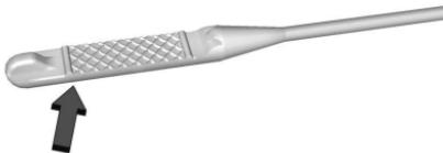
엔진 오일 레벨이 딥스틱 끝의 십자 무늬 밑에 오고 엔진이 최소 15분간 정지해 있었다면 권장 엔진 오일을 1리터 이상 보충하고 레벨을 다시 점검하십시오. 어떤 종류의 엔진 오일을 사용해야 하는지는 본 단원 뒤에 나오는 '엔진 오일 선택'을 참조하십시오. 엔진 오일 크랭크케이스의 용량은 386페이지의 '용량과 규격'을 참조하십시오.
