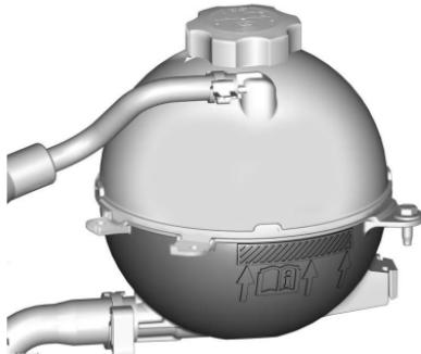
냉각수 탱크에 냉각수가 보이는지 확인하십시오. 냉각수 탱크에서 냉각수가 끓을 때는 냉각수가 식을 때까지 아무 동작도 취하지 마십시오. 냉각수 탱크에 냉각수가 보이지만 냉각수 레벨 표시가 보이지 않으면 마실 수 있는 깨끗한 물과 DEX-COOL 냉각제를 50 대 50으로 혼합하여 냉각수 탱크 중앙부 위쪽 라인까지 넣으십시오. 이에 앞서 냉각 시스템이 식었는지 확인하십시오. 307페이지의 '엔진 과열'을 참조하십시오.
