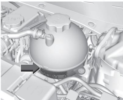
냉각수 탱크에 냉각수가 보이는지 확인하십시오. 냉각수 탱크에서 냉각수가 끓을 때는 냉각수가 식을 때까지 아무 동작도 취하지 마십시오. 냉각수가 보이지만 냉각수 레벨이 표시된 마크 밑에 올 때는 마실 수 있는 깨끗한 물과 DEX-COOL 냉각제를 50 대 50으로 혼합한 냉각수로 보충하십시오. 냉각수를 보충하기 전에 냉각 시스템이 식었는지 확인하십시오. 323페이지의 '엔진 과열'을 참조하십시오.
