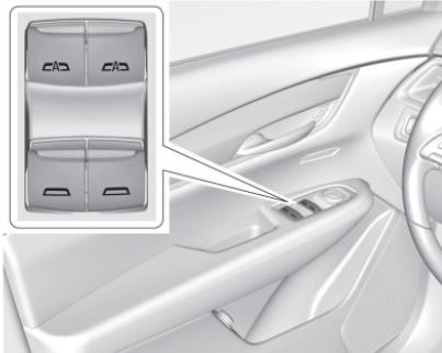
전동 윈도우는 시동 스위치가 켜져 있거나 액세서리 모드에 있을 때 또는 액세서리 전원 유지(RAP) 기능이 작동할 때 열고 닫을 수 있습니다. 235페이지의 '액세서리 전원 유지(RAP)'를 참조하십시오.
