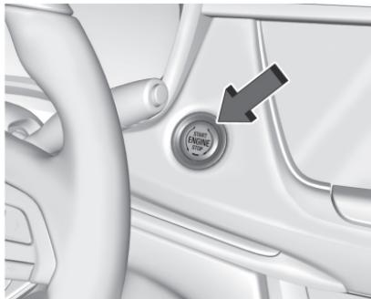
차에 버튼(ENGINE START/STOP 버튼)을 눌러 시동을 거는 전자 키리스 시동 시스템(키 없이 시동을 거는 시스템)이 있습니다.
