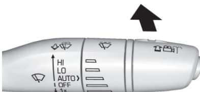
후방 카메라 렌즈에 워셔액을 분사시키려면 앞유리 와이퍼 레버를 앞으로 밀니다. 앞유리 와이퍼 레버는 자동으로 시작 위치로 돌아갑니다. 38페이지의 '후방 카메라 미러'를 참조하십시오.
