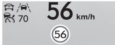
**속도 화면** : 앞차 표시등, 차선이탈 경고/차선유지 보조 표시등, 어댑티브 크루즈 컨트롤 표시등과 함께 제한 속도와 설정 속도가 영미 단위나 미터 단위로 표시됩니다. 일부 정보는 관련 기능이 있는 차량에서 해당 기능이 작동할 때만 표시됩니다.
