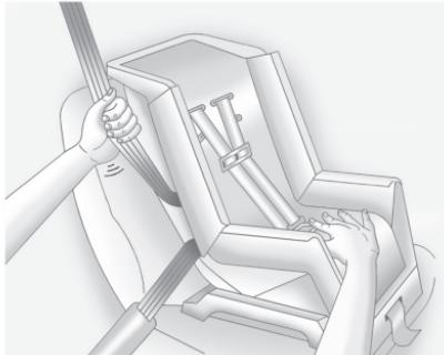
5. 안전벨트를 조이려면 어린이 안전시트를 밑으로 누르면서 어깨벨트를 당겨 허리벨트를 조이고 어깨벨트를 리트랙터로 들여보냅니다. 전향 어린이 안전시트를 설치할 때는 무릎으로 어린이 안전시트를 밑으로 누르면서 안전벨트를 조이는 것이 편리합니다.
