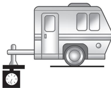
트레일러 연결대 중량은 차량 총중량(GVW)에 영향을 미칩니다. GVW에는 공차 중량, 승객 중량, 화물 중량, 장비 중량, 트레일러 연결대 중량이 포함됩니다. 차량 옵션, 탑승자, 화물, 장비는 차가 수용할 수 있는 최대 허용 연결대 중량을 낮추고 따라서 최대 허용 트레일러 중량을 낮춥니다.
