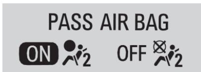
시스템 점검이 이루어지는 동안 ON과 OFF라는 단어가 나타나거나 ON과 OFF에 해당하는 심벌이 나타납니다. 시스템 점검이 완료되면 ON과 OFF라는 단어 중 하나나 ON과 OFF에 해당하는 심벌 중 하나가 나타납니다. 125페이지의 '동승석 에어백 상태 표시등'을 참조하십시오.
