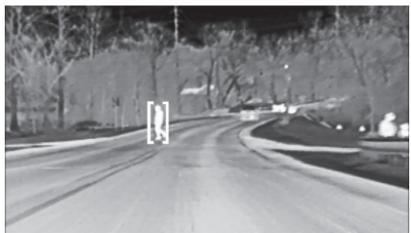
전방 보행자 브레이크 시스템을 켜 놓으면 차가 보행자나 동물에 너무 빨리 접근할 때 나이트 비전 시스템이 HUD에 적색 경고등을 끔니다. 이와 더불어 경고음이 나거나 운전석(안전경고 기능 내장시)이 진동할 수도 있습니다. 281페이지의 '전방 보행자 브레이크 시스템(FPB)'을 참조하십시오.
