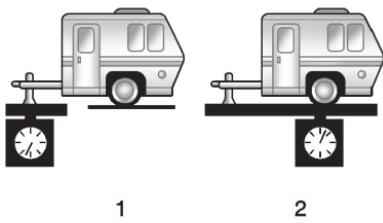
트레일러 연결대의 중량(1)은 적재된 트레일러 총중량(2)의 10~15%가 되어야 합니다. 일부 특수 트레일러(보트 트레일러 등)에는 이들 수치가 적용되지 않습니다. 트레일러 사용 설명서에 나오는 권장 트레일러 연결대 중량을 참조하십시오. 차량, 히치, 트레일러의 최대 허용 하중이 초과되지 않도록 하십시오.
