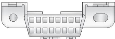
DLC는 스티어링휠 좌측 계기판 밑에 있습니다. 배출가스 검사/정비 테스트나 차량 정비에 사용되지 않는 장비를 DLC에 연결하면 차의 작동이 영향을 받을 수 있습니다. 299페이지의 '전기 장비의 초기'를 참조하십시오. 도움이 필요하면 서비스 센터에 연락하십시오.
