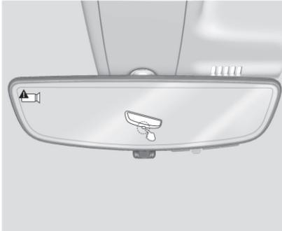
미러에 청색 스크린과 ▲ 표시가 나타난 후 화면이 꺼지면 시스템에 정비가 필요한 것이므로 서비스 센터에 연락하십시오. 자동 눈부심 방지 모드로 돌아가려면 표시된 방식으로 탭을 누릅니다.
