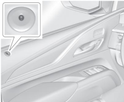
운전석 윈도우 근처에 위치한 표시등이 시스템의 상태를 나타냅니다. 20페이지의 '파워 도어 잠금장치'를 참조하십시오.
