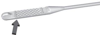
엔진 오일 레벨이 디스틱 끝의 십자 무늬 밑에 오고 엔진이 최소 15분간 정지해 있었다면 권장 엔진 오일을 1리터 이상 보충하고 레벨을 다시 점검하십시오. 어떤 종류의 엔진 오일을 사용해야 하는지는 본 단원 뒤에 나오는 '엔진 오일 선택'을 참조하십시오. 엔진 오일 크랭크케이스의 용량은 411페이지의 '용량과 규격'을 참조하십시오.
