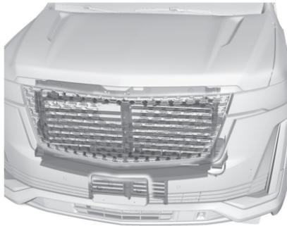
차에는 전방 냉각구(cooling opening)를 자동으로 닫는 셔터 시스템이 있을 수 있습니다. 차에 연비를 높이는 셔터 시스템이 있을 수 있습니다. 셔터 시스템에서 눈, 얼음 등의 이물질을 제거하십시오. 엔진점검 경고등이 켜지면 셔터 시스템에 눈, 얼음 등의 이물질이 없는지 점검하십시오.
