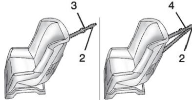
상부 묶음띠(3/4)는 어린이 안전시트 상부를 차에 고정시키는 데 사용합니다. 차에 한 개의 상부 묶음띠 앵커가 만들어져 있습니다. 어린이 안전시트의 상부 묶음띠 부착구(2)를 차의 상부 묶음띠 앵커에 연결하면 운전할 때나 충돌이 있을 때 어린이 안전시트가 앞으로 쏠리거나 돌아가는 것이 방지됩니다.
