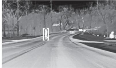
전방 보행자 브레이크 시스템을 켜 놓으면 차가 보행자나 동물에 너무 빨리 접근할 때 나이트 비전 시스템이 HUD에 적색 경고등을 켵니다. 이와 더불어 경고음(삐소리)이 나거나 운전석(안전경고 기능 내장시)이 진동할 수도 있습니다. 278페이지의 '전방 보행자 브레이크 시스템(FPB)'을 참조하십시오.
