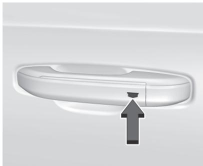
열거나 잠그려는 도어에서 1m 이내에 리모트 키가 있어야 합니다. 도어를 해제하고 열려면 해당 도어 외부핸들 안쪽 그림의 스위치를 누릅니다. 도어를 잠그려면 해당 도어 외부핸들 앞면의 센서를 터치합니다. 9페이지의 '리모트 키 작동' 항목에 나오는 '키리스 개폐 기능'을 참조하십시오.
