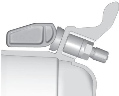
트레일러 타이어에 TTPMS 센서를 설치하려면 트레일러 서비스 센터나 타이어 서비스 센터에 연락하십시오. 기술자가 센서 스템을 트레일러 휠의 구멍에 삽입해야 합니다. 센서가 자리를 잡으면 센서 스템의 너트를 8N.m으로 조여야 합니다. 트레일러 휠에 타이어를 장착할 때는 센서를 손상시키지 않도록 조심하십시오.
