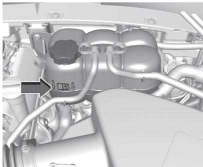
냉각수 탱크에 냉각수가 보이는지 확인하십시오. 냉각수 탱크에서 냉각수가 끓을 때는 냉각수가 식을 때까지 아무 동작도 취하지 마십시오. 냉각수 레벨이 그림의 화살표 표시 위에 와야 정상입니다. 냉각수 레벨이 화살표 표시 위에 오지 않으면 냉각 시스템에 누출이 있을 수 있습니다.
