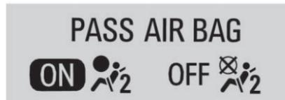
시스템 점검이 이루어지는 동안 ON과 OFF라는 단어가 나타나거나 ON과 OFF에 해당하는 심볼이 나타납니다. 시스템 점검이 완료되면 ON과 OFF라는 단어 중 하나나 ON과 OFF에 해당하는 심볼 중 하나가 나타납니다. 130페이지의 '동승석 에어백 상태 표시등'을 참조하십시오.
