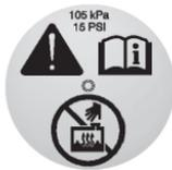
1. 냉각 시스템(압력캡과 상부 라디에이터 호스 포함)이 뜨겁지 않을 때 압력캡을 분리합니다. 압력캡을 시계 반대방향으로 천천히 한 바퀴 돌리십시오. 바람 빠지는 소리가 나면 소리가 멈출 때까지 기다리십시오. 바람 빠지는 소리가 나면 냉각수 탱크에 압력이 있는 것입니다.
