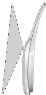
도어가 전동으로 열릴 때 도어 경로에서 장애물이 탐지되면 도어가 자동으로 멈춥니다. 전동 도어 시스템은 도어가 전동으로 열릴 때 도어 쪽으로 이동하는 장애물로 인해 발생하는 충동을 방지할 수 없습니다. 도어가 전동으로 닫힐 때는
