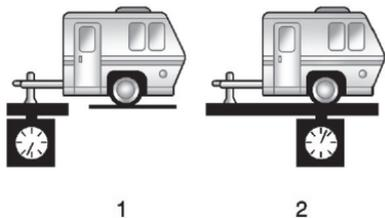
트레일러 연결대의 중량(1)은 적재된 총 트레일러 중량(2)의 10~15%가 되어야 합니다. 일부 특수 트레일러(보트 트레일러 등)에는 이를 수치가 적용되지 않습니다. 트레일러 사용 설명서에 나오는 권장 트레일러 연결대 중량을 참조하십시오. 차량, 히치, 트레일러의 최대 허용 하중이 초과되지 않도록 하십시오.
