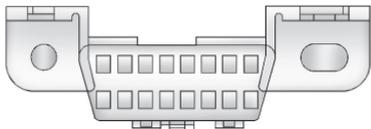
DLC는 스티어링휠 좌측 계기판 밑에 있습니다. 배출가스 검사/정비 테스트나 차량 정비에 사용되지 않는 장비를 DLC에 연결하면 차의 작동이 영향을 받을 수 있습니다. 312페이지의 '전기 장비의 추가'를 참조하십시오. 도움이 필요하면 서비스 센터에 연락하십시오.
