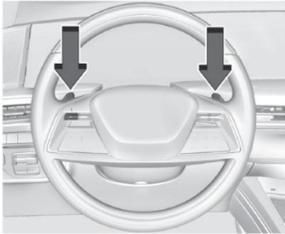
ERS 모드(수동 모드)에서는 수동으로 기어 위치를 선택할 수 있습니다. 내리막길에서 운전할 때나 트레일러를 견인할 때 이 모드를 사용하면 고속 기어와 차량 속도가 제한됩니다. DIC 내 기어 위치 표시창의 L 옆에 표시되는 숫자는 사용 가능한 최고 기어를 가리킵니다.
