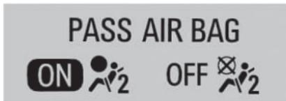
시스템 점검이 이루어지는 동안 ON과 OFF라는 단어가 나타나거나 ON과 OFF에 해당하는 심볼이 나타납니다. 시스템 점검이 완료되면 ON과 OFF라는 단어 중 하나나 ON과 OFF에 해당하는 심볼 중 하나가 나타납니다. 107페이지의 '동승석 에어백 상태 경고등'을 참조하십시오.
