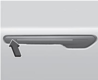
모든 도어의 잠김을 해제하거나 아무 도어나 열거나 닫으면 모든 도어핸들이 나옵니다. 리모트 키가 차에 접근하면 모든 도어핸들이 나오도록 프로그램할 수도 있습니다. 인포테인먼트 화면에서 사용 가능한 세팅을 보려면 Settings(설정) > Vehicle(차량) > 'Remote Lock, Unlock, Start(원격 잠금, 잠금 해제 및 시동)'를 터치합니다.
