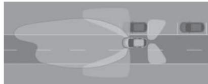
조작 라이트(장착시)는 기어가 R에 있고 차량 속도가 7km/h 미만일 때 자동으로 켜집니다. 주차 할 때와 같이 차를 앞뒤로 조작하는 상황에서 조명이 개선됩니다.
