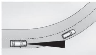
앞차를 따라 커브길에 들어설 때는 ACC가 앞차를 탐지하지 못하여 차를 설정 속도로 가속시킬 수도 있는데 이런 경우에는 화면에 전방 차량 경고등이 나타나지 않습니다.
