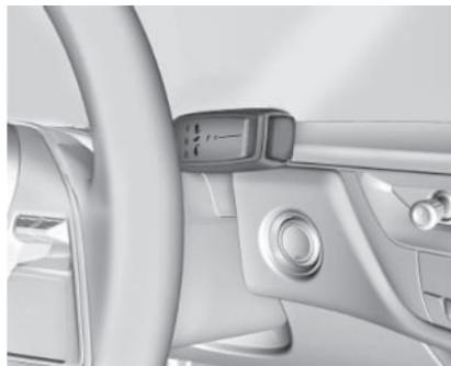
차에 드라이브 유닛이 사용됩니다. 기어 셀렉터 전면에 변속 패턴이 표시되어 있습니다. 기어를 선택하면 기어 셀렉터에 해당 기어가 적색으로 표시되고 다른 기어는 백색으로 표시됩니다. 기온이 매우 낮아 기어가 바로 체결되지 않으면 기어 셀렉터 스위치의 표시등이 깜박이다가 기어가 체결되면 멈춥니다.
