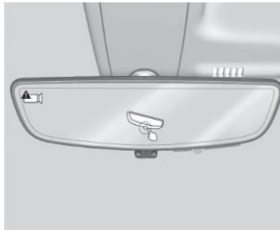
미러에 청색 스크린과 표시가 나타난 후 화면이 꺼지면 시스템에 정비가 필요한 것으로 서비스 센터에 연락하십시오. 눈부심 자동 방지로 돌아가려면 표시된 방식으로 탭을 누릅니다.
