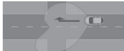
도시에서 주행할 때 차량 속도가 30km/h와 55km/h 사이에 들어오면 타운 라이트(장착시)가 자동으로 켜집니다.
